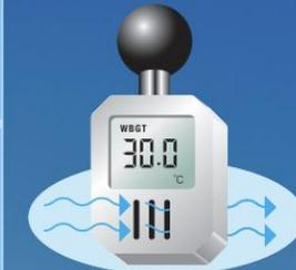
日向では計測器自体が熱くなりやすく、正確な温度を計測するには、計測器内部に熱をこもらせないように、常に外気を取り入れるための通気口が必要となります。
